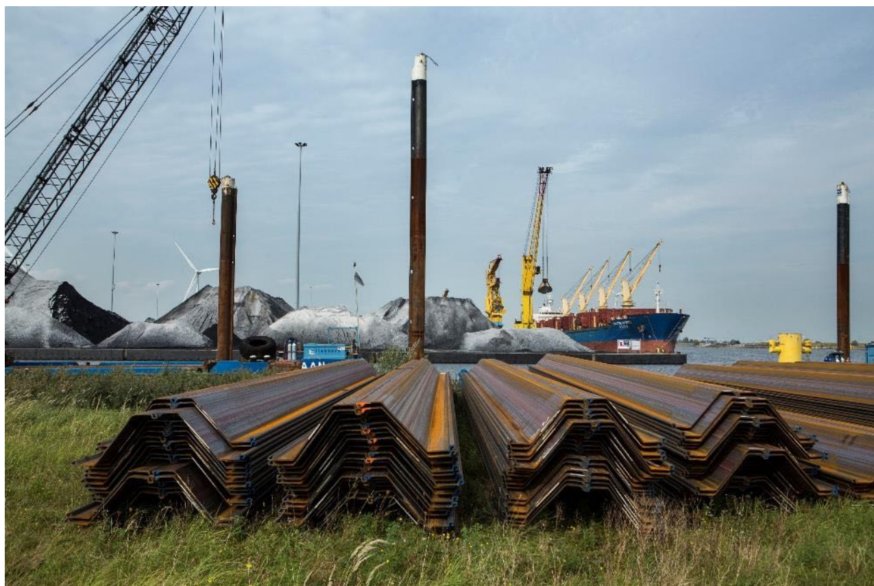
Figuur 1. Hergebruik damwanden. Foto door Johannes Abeling (bron: beeldbank provincie Noord-Holland).
